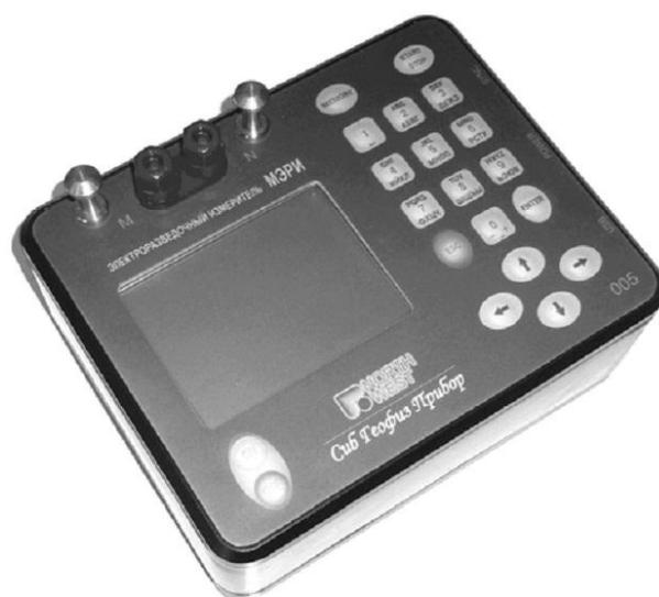
При проведении исследований в частотной модификации метода ВП с малыми разнесами можно применять портативную аппаратуру, например, генератор «АСТРА» и измеритель «МЭРИ-24» (производство ООО «Северо-Запад», г. Москва).
